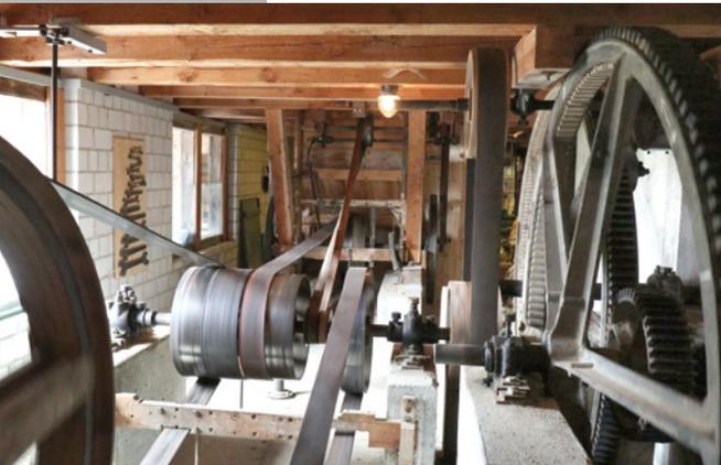
*Kraftübertragung vom Wasserrad zur Gattersäge mittels des komplexen Getriebes*
